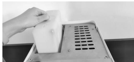
6. Volver a introducir el depósito. Asegurarse que el extremo con el filtro queda sumergido y en el fondo del depósito. Volver a poner la tapa del depósito.
